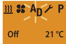
Nach der Anzeige ZUSATZGERÄT OFF wird die Startanzeige angezeigt. Bei Fahrzeugbeleuchtung AUS erlischt die Beleuchtung des Displays nach 10 Sekunden.
