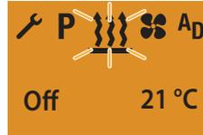
Nach der Anzeige HEIZEN OFF wird die Startanzeige angezeigt. Bei Fahrzeugbeleuchtung AUS erlischt die Beleuchtung des Displays nach 10 Sekunden.
