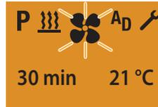
Anzeige bei Luftheizgeräten im Dauerbetrieb LÜFTEN.
