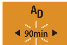
Betriebsdauer mit der Taste ◻ bestätigen. Die Betriebsdauer wird bleibend geändert.
