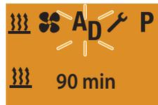
Anzeige bei Luftheizgeräten im Dauerheizbetrieb (Werkseinstellung).
