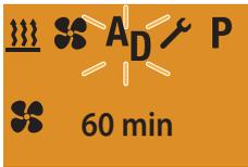
Anzeige bei Luftheizgeräten im Dauerbetrieb LÜFTEN (Werkseinstellung).
