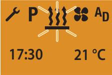
Die Startanzeige wird, wenn kein Menüpunkt aktiviert ist, mit einem blinkenden Heizsymbol mittig in der Menüleiste, mit der aktuellen Uhrzeit und der Isttemperatur im Statusbereich angezeigt.
