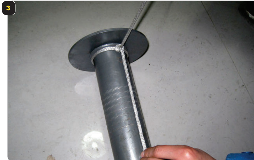
Legen Sie das Ende des Seils längs auf die Seiltrommel
