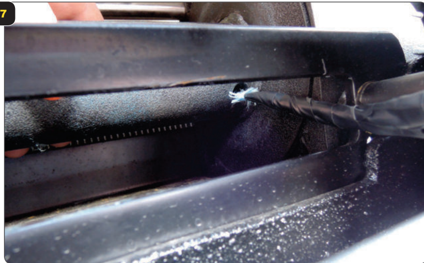
Das Seil in die Seilaufnahme stecken - Achtung - Madenschraube nicht anziehen
