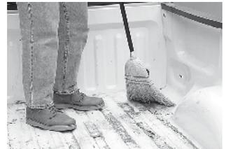
**HINWEIS** Stellen Sie sicher, dass alle angestrichenen Oberflächen, wo HERCULINER aufgetragen werden soll, angeschliffen werden, damit keine glänzenden Oberflächen bleiben. Dies erzeugt eine hervorragende Haftung zwischen HERCULINER und der Oberfläche der Ladefläche.
