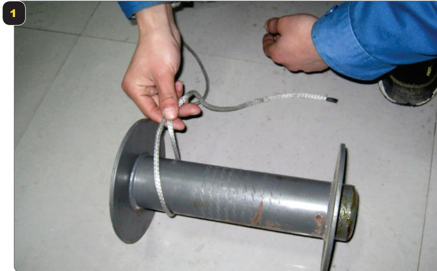
Nehmen Sie das Kunststoffseil und wickeln sie eine Schlaufe um die Seiltrommel.
