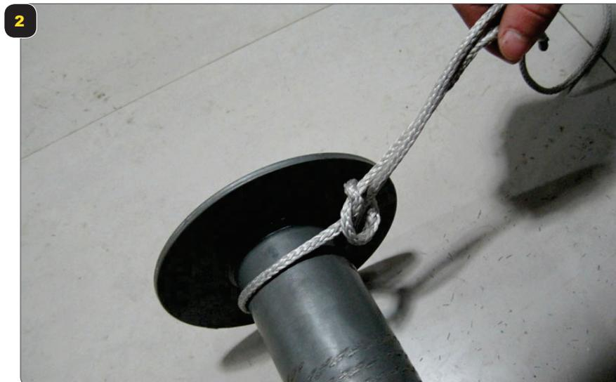
Bilden Sie einen Knoten und schieben den bis an das Ende der Seiltrommel
