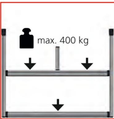
Eine Fahrzeugeinrichtung kann in Felder eingeteilt werden. Ein Feld ist ein Bereich zwischen zwei SLF Seitenteilen, welche mit dem botten Fahrzeugboden direkt verbunden sind.
