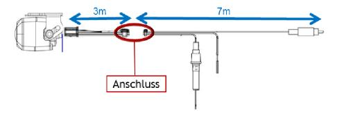
Der Anschlusskontakt des Kamerakabels ist 3m vom Kameragehäuse entfernt und kann so feuchtigkeitsgeschützt innerhalb der Karosserie verlegt werden. ND-BC8
